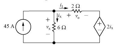
$$-v_{\rm x} + v_{\rm o} + 2i_{\rm x} = 0 \qquad (KVL)$$
